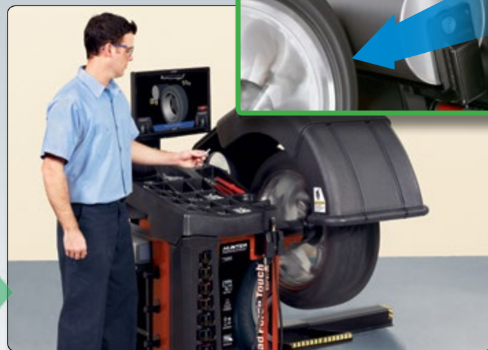
NOVINKA! Zatímco si obsluha připravuje závaží, provede se jízdní test.
