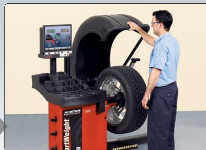
Technik zvedne kryt, namontuje závaží a následně provede kontrolní rotaci
